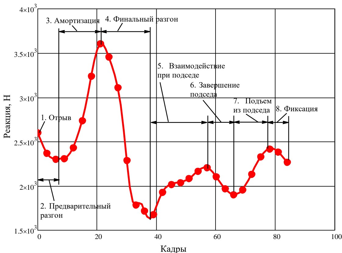
Рис. 12 – Структура рывка при силовом анализе. Вес 140 кг
